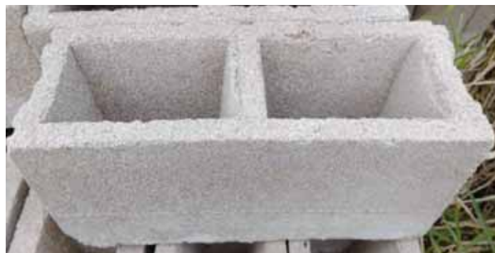
Ladrillos paredes exteriores (grandes).
