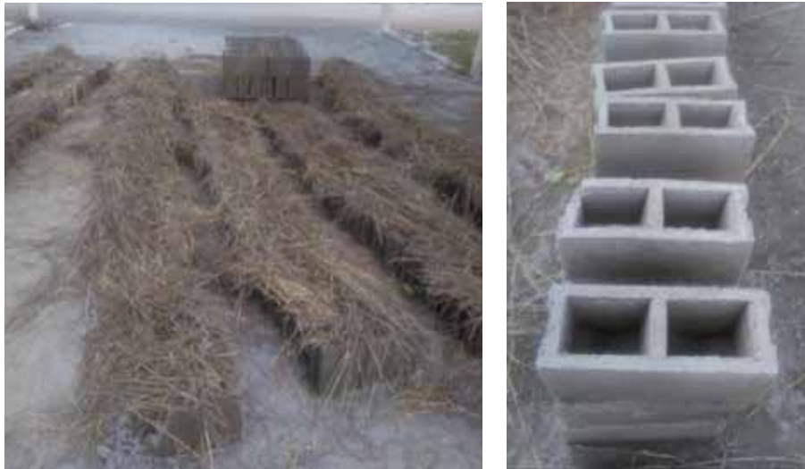
Secado a la izq. y aspecto final de los ladrillos a la dcha.
